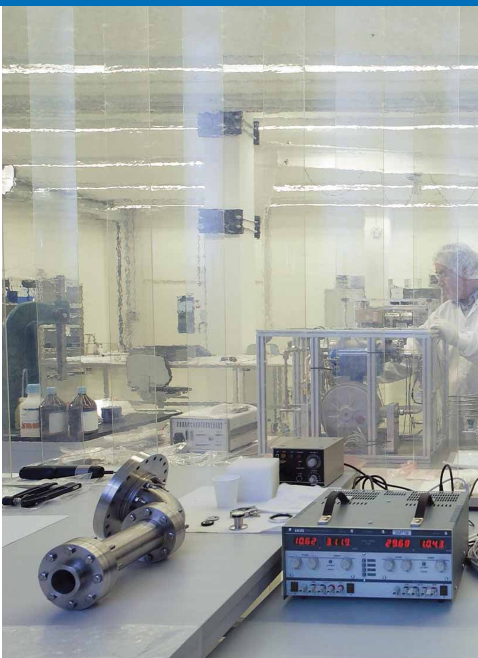
Travail en salle blanche sur un sous-système vide à gaz, destiné au laboratoire de recherche sur les matériaux de la Station spatiale internationale
