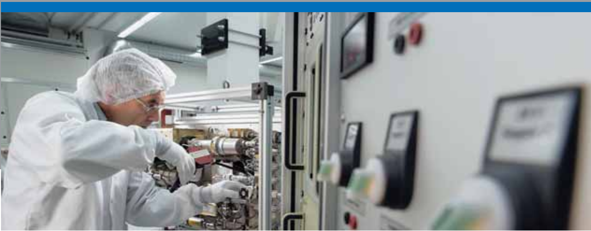
Structure de test pour la pompe à ammonium et à eau dans le circuit de refroidissement de satellites
