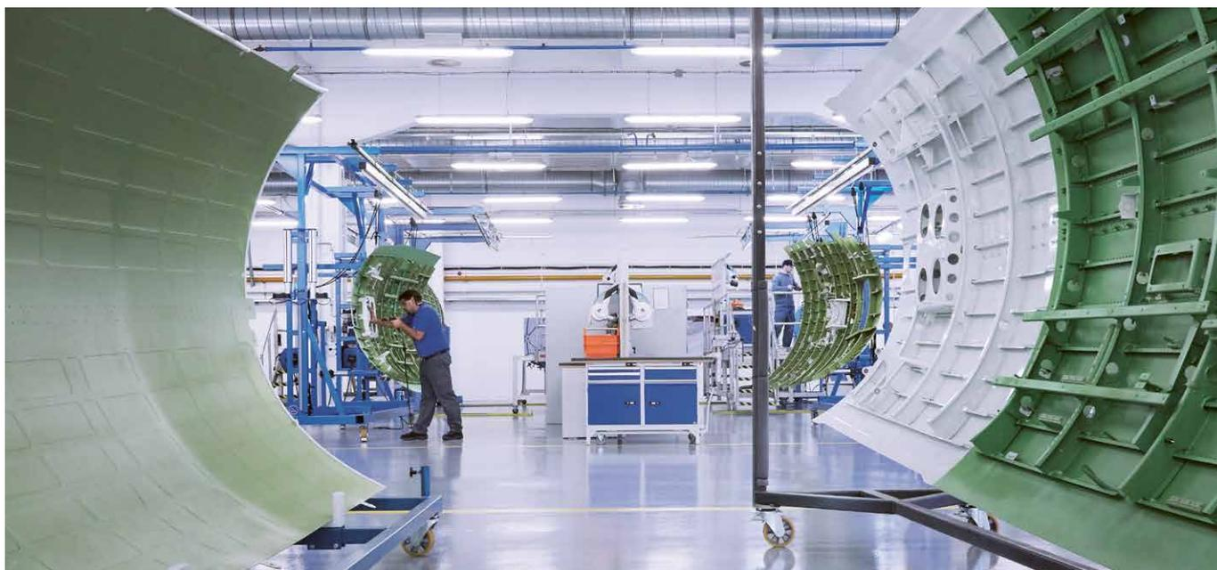
La division Aerostructures développe, fabrique et monte des composantes de structures d'avions, notamment des sections de fuselage complètes ainsi que des composantes d'ailes et de gouverne. RUAG Aerostructures pilote
