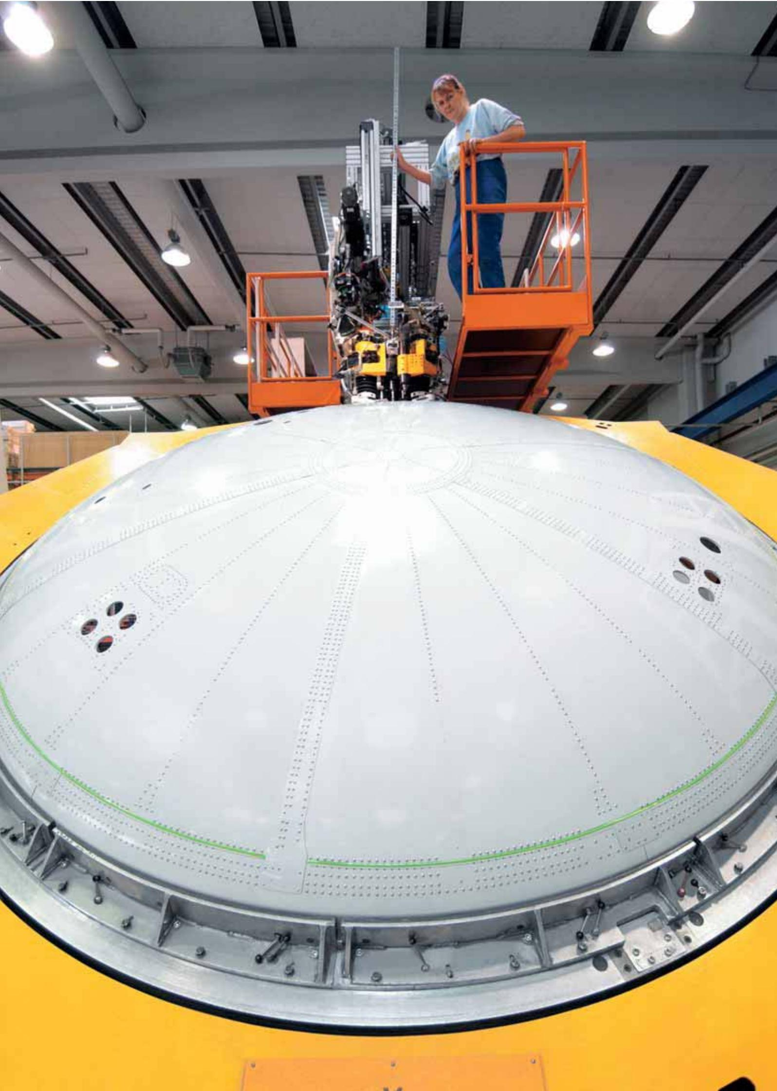
schalenförmige Bauteile bis zu einer maximalen Grösse von 11 x 4 m verarbeitet werden. Damit sind Schalen für alle heute bekannten Rumpfdurchmesser aller Flugzeugbauer herstellbar, mit Ausnahme des A380. Dies gilt sowohl für Hersteller von Grossraum- als auch von Regionalflugzeugen.
