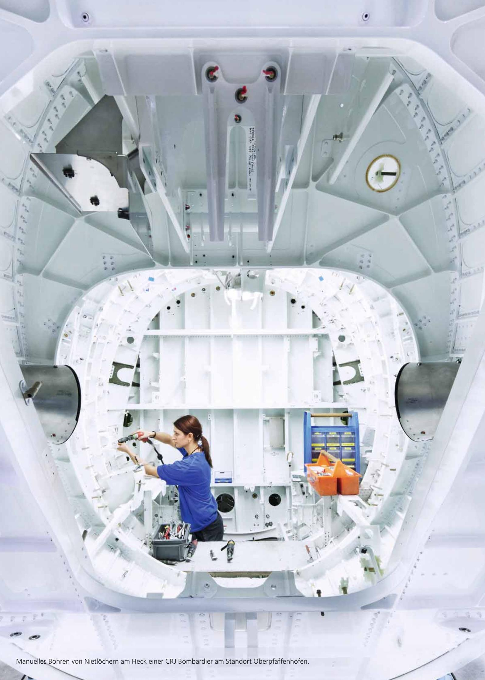
Manuelles Bohren von Nietlöchern am Heck einer CRJ Bombardier am Standort Oberpfaffenhofen.
