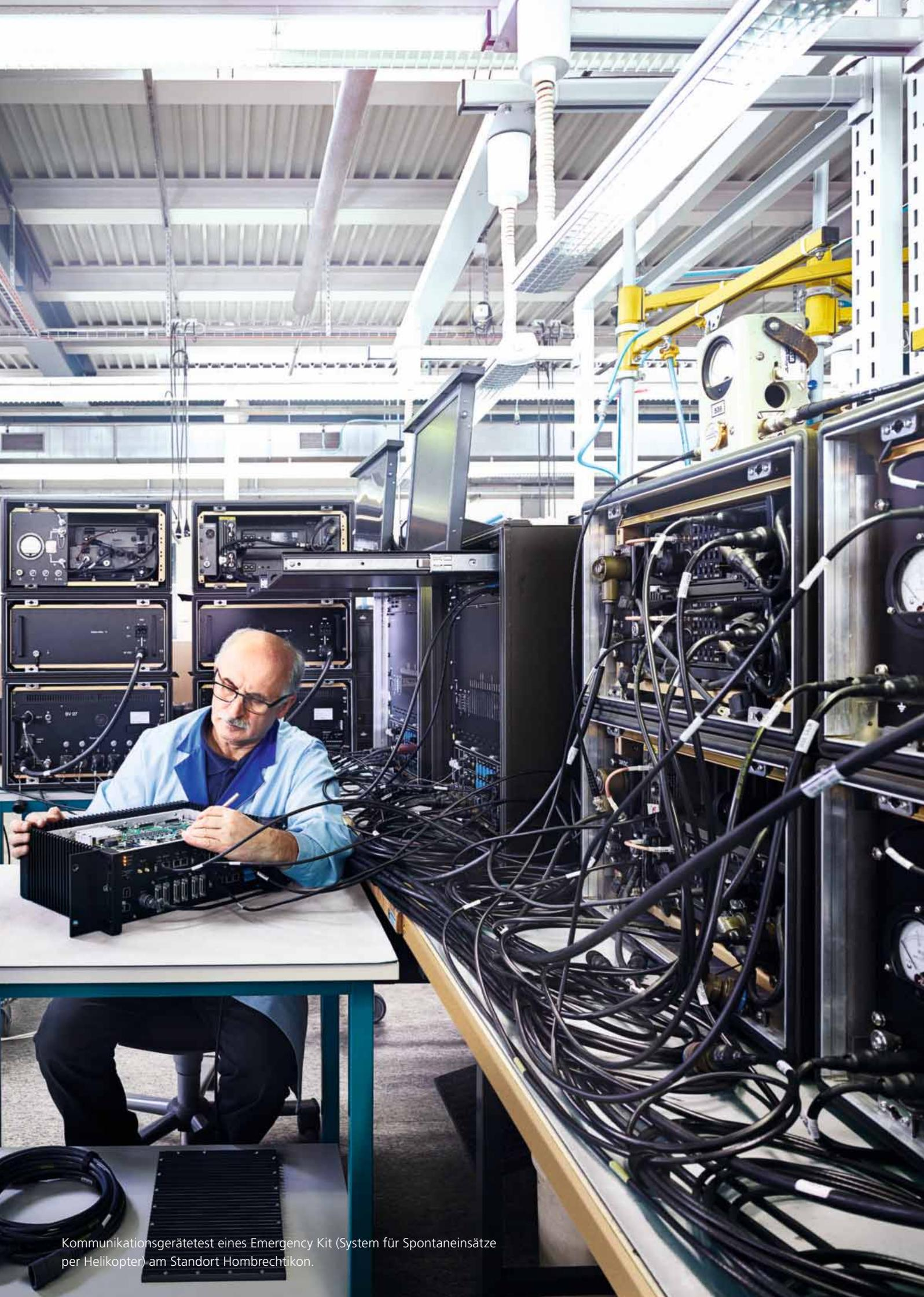
Kommunikationsgerätetest eines Emergency Kit (System für Spontaneinsätze per Helikopter) am Standort Hombrechtikon.
