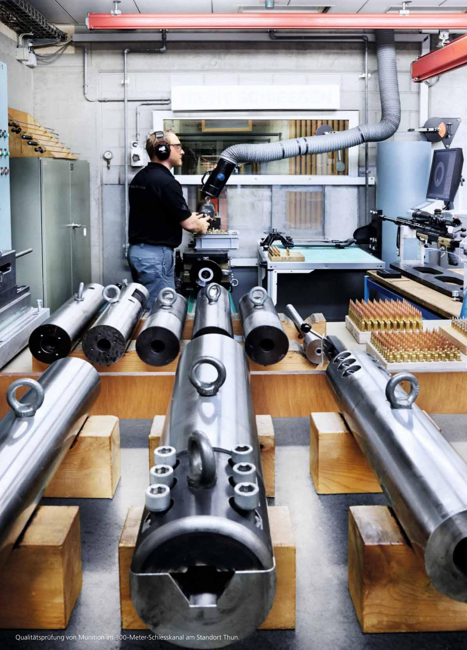
Qualitätsprüfung von Munition im 300-Meter-Schiesskanal am Standort Thun.
