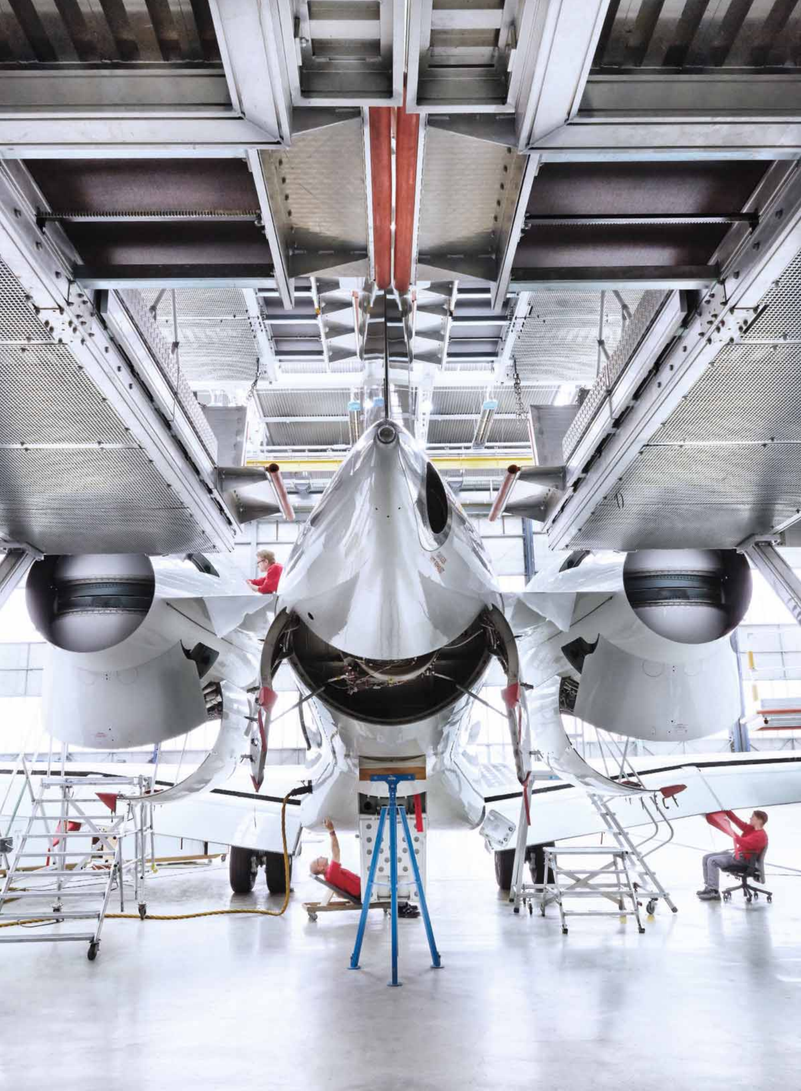
Travaux de maintenance sur un avion d'affaires Bombardier Global Express sur le site d'Oberpfaffenhofen.
