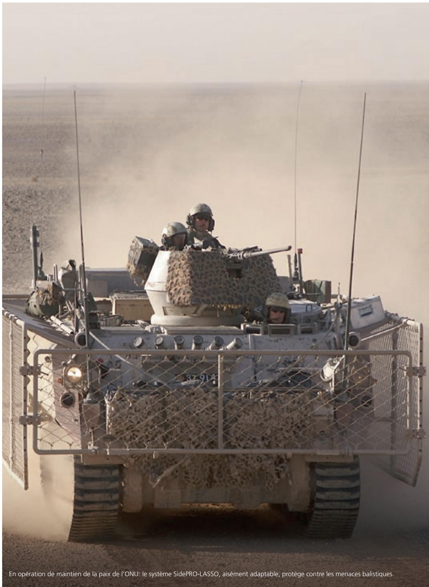
En opération de maintien de la paix de l'ONU: le système SidePRO-LASSO, aisément adaptable, protège contre les menaces balistiques.
