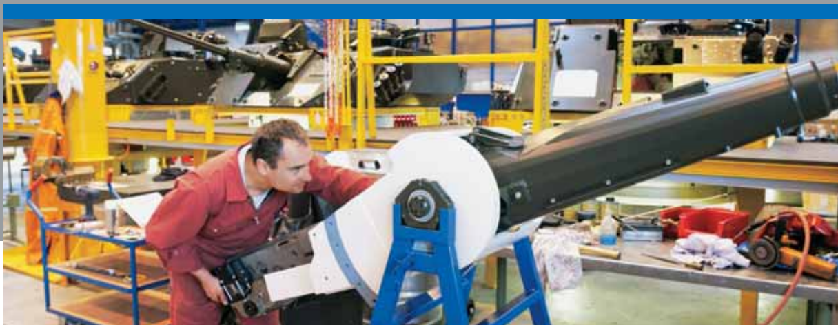
Vormontage der Kanone für den neuen Schützenpanzer
