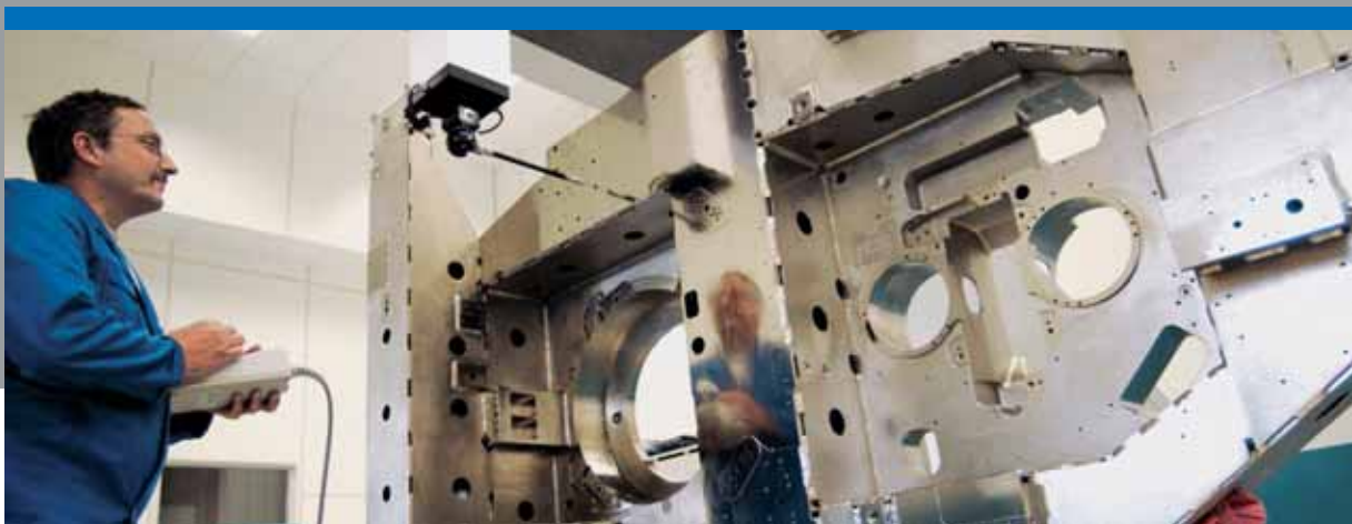
Hochpräziser Maschinenrahmen in der Qualitätskontrolle
